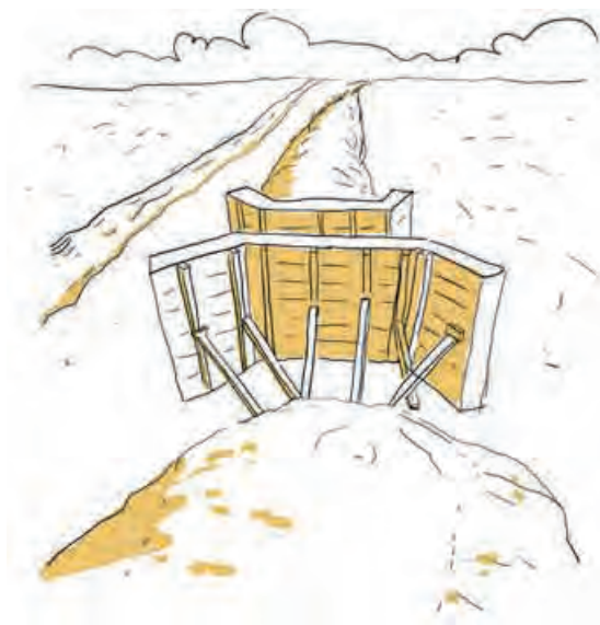
Construction d'un ouvrage évacuateur : coffrage
